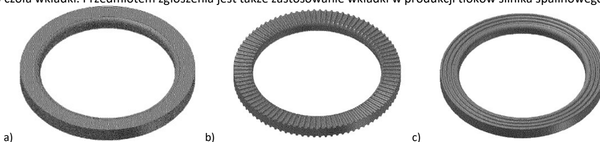
Rys. 1. Wkładka kompozytowa pod rowek pierścienia tłoka silnika spalinowego: a) rozwiązanie ze stanu techniki, np. US 5671710, b) i c) rozwiązania według wynalazku.
