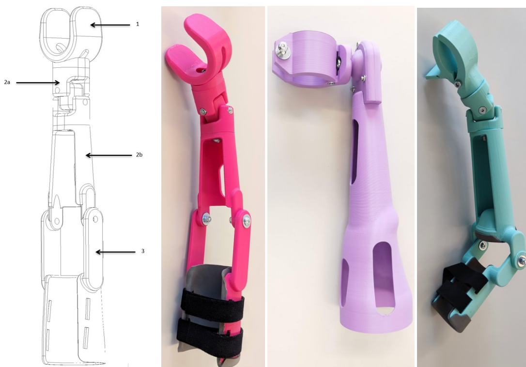
Rys. 1 . Schemat i budowa modułowej protezy ręki przeznaczonej dla dzieci niepełnosprawnych do współpracy z kierownicą roweru lub hulajnogi.
